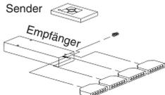
Mit dieser Fernbedienung können max. 4 Stromkreise geschaltet und gedimmt werden. Pro Stromkreis sind 6 Leuchtkörper möglich. Die Fernbedienung wird, falls gewünscht zwischen Vorschaltgerät und Beleuchtung gesteckt.                                                                                                                                                                                                                                                                                        |
