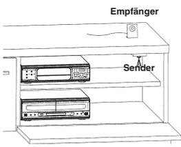
Der IR Repeater verlängert die Reichweite handelsüblicher IR Fernbedienungen in das Möbellinnere. Es können so z.B. DVD-Player hinter einer geschlossenen Klappe bedient werden. Ankommende IR-Befehle der Gerätefernbedienung werden über den Empfänger aufgenommen, verstärkt und über den Sender ins Möbellinnere weitergeleitet. Vorteil, der Repeater leitet nur Signale weiter, er benötigt keine eigene Fernbedienung. Zum Betrieb ist ein Netzanschluß mit 220 Volt erforderlich.<br><br>IR=infrarot |
