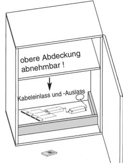
Bitte angeben bei welchem Element der Einbau erfolgen soll. Die integrierte Funkfernbedienung hat 4 Anschlüsse. Es können max. 4 Stromkreise geschaltet und gedimmt werden. Die obere Abdeckung ist ein abnehmbarer Holzboden, der Schrank bleibt deshalb in voller Tiefe nutzbar. Ein Vorschaltgerät <b>LEVG15</b> oder <b>LEVG30</b> ist zusätzlich erforderlich!                                                                                                                                          |
