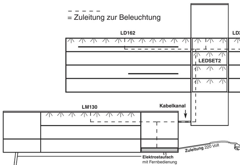
Funkempfänger, Verteilungen und Vorschaltgeräte werden im Elektrostaufach deponiert. Geschaltet wird über die Fernbedienung, es können 4 unterschiedliche Stromkreise mit der Fernbedienung geschaltet und gedimmt werden.
